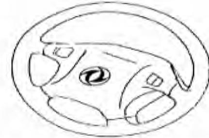
Para verificar su desplazamiento en vacío, gire el volante lentamente de izquierda a derecha. El desplazamiento en vacío del volante en la circunferencia es de 0-30 mm. El giro del volante debe ser liviano, suave y silencioso.
