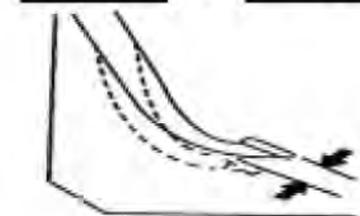
El desplazamiento normal del pedal de embrague es 15-25 mm. por lo que cualquier desplazamiento inferior o superior a tal rango deberá ser corregido y ajustado.
