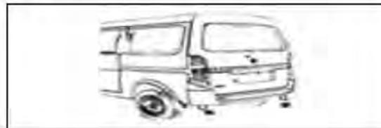
Mientras el vehículo está siendo remolcado, las ruedas frontales deben estar en contacto con el suelo mientras que las ruedas traseras deberán estar levantadas. El usuario deberá colocar la chapa del encendido en la posición ‘ACC’ para soltar el volante. El volante quedará asegurado mediante un sistema de bloqueo especial.
