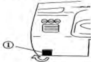
La manija para abrir la maleta desde el interior del vehículo se ubica debajo y hacia la izquierda del tablero de instrumentos. Para abrir tal cubierta frontal, el usuario deberá tirar de la manija hacia fuera y después hacia arriba.
