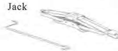
La gata hidráulica y su palanca de accionamiento deben estar siempre en su lugar de guarda en la parte frontal
