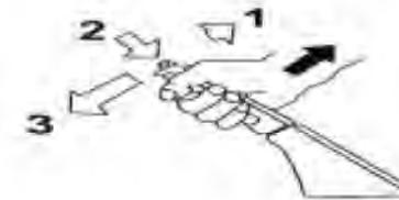
Al levantar la palanca del freno de mano el vehículo se detendrá. Para soltar el freno de mano y volverlo a su posición normal, solo tire de la palanca del freno un poco hacia arriba y presione con el pulgar el botón que se ubica en el extremo de la palanca.
