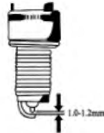
Las bujías de su vehículo son del tipo F6TC (4C7T) y su hilo es M14 \* 1. 25. Con la acumulación de carboncillo o suciedad en la bujía la producción de la chispa eléctrica se
