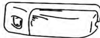
Como lo indica la figura, se debe usar un abridor para retirar el vidrio protector then tomándolo con un paño protector para luego proceder a remover y cambiar la ampolleta defectuosa.
