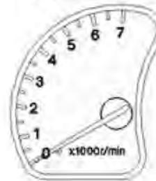
Indica la velocidad de giro del motor en miles de revoluciones por minuto (1000 rpm)
