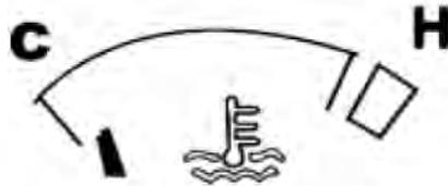
Durante la conducción, la temperatura del agua deberá mantenerse dentro del rango normal, esto es entre 'C' y 'H'. Cuando el indicador se mueva hacia el punto 'H' y lo sobrepase significa que el motor se ha calentado en exceso y el conductor deberá detener el vehículo.
