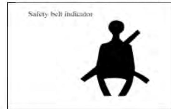
Al activar el encendido, este indicador se iluminará en el panel de instrumentos para luego apagarse una vez que la hebilla del cinturón de seguridad haya sido insertada en su respectivo enganche, confirmando así de que el cinturón de seguridad está
