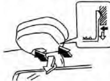
Aquí el usuario deberá desconectar la alimentación eléctrica y después empujar hacia adelante la fijación trasera, deslizar hacia atrás la tapa de la caja para proceder a retirar y cambiar la ampolleta defectuosa.
