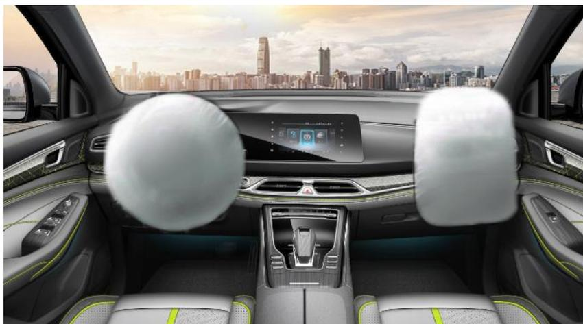
Despliegue de las bolsas de aire del conductor y del pasajero
