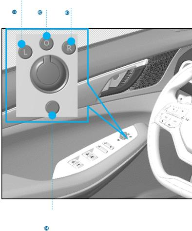
1. Ajuste del retrovisor exterior: gire el interruptor para seleccionar **L** o **R** (izquierda o derecha), y gire el mando de ajuste para ajustar correspondientemente los ángulos arriba, abajo, izquierda y derecha de las lentes del retrovisor exterior;
