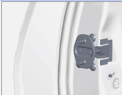
La puerta no puede abrirse desde el interior del vehículo cuando el pestillo de bloqueo está en la posición "Bloqueado". Para abrir esta puerta, debe utilizar el tirador situada en el exterior del vehículo.
