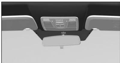
Antideslumbramiento manual: para entrar en el modo antideslumbramiento, gire hacia atrás la palanca de ajuste situada en la parte inferior central del retrovisor interior; para salir del modo antideslumbramiento, gire hacia delante la palanca de ajuste situada en la parte inferior central del retrovisor interior.
