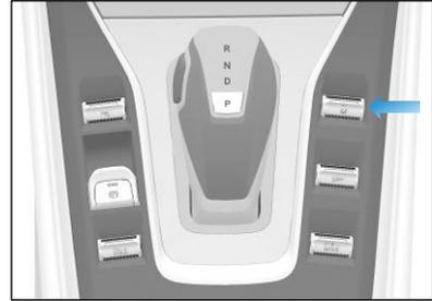
Si la luz indicadora en el salpicadero se enciende después de pulsar el interruptor de desconexión del ESC durante menos de 10s, significa que el ESC se ha desconectado y las funciones TCS y ESC quedarán desactivadas. Vuelva a pulsar el interruptor de desconexión del ESC y la luz indicadora del aparato se apagará. Indica que el ESC está activado de nuevo.
