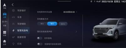
6. Conecte la función de descarga externa a través del panel de control central.
